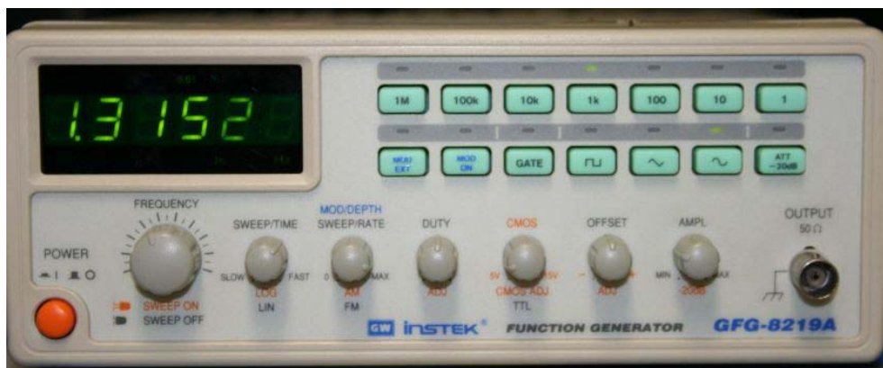
Hình 1.1.12: Máy phát sóng Instek
